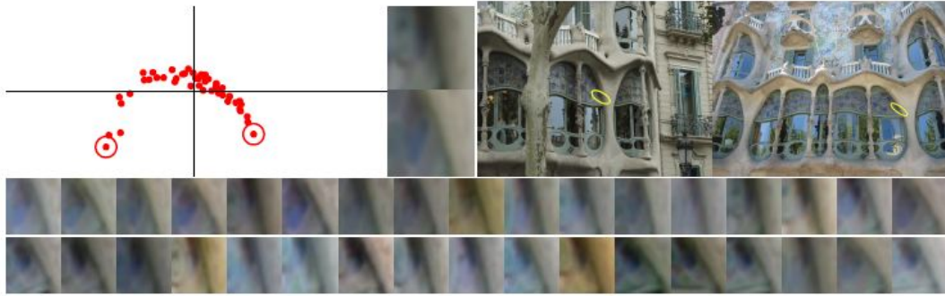
Σχήμα 5.4: Ένα παράδειγμα με αντίστοιχα patches. Μία προβολή PCA των descriptors στο χώρο δύο διαστάσεων με τον κόκκινο κύκλο τα 2 πιο μακρινά patches (αριστερά); τα δύο πιο διακριτά patches στο χώρο των SIFT descriptors και οι φωτογραφίες που προέρχονται (δεξιά); Ένα σύνολο από όμοια patches (κάτω).
