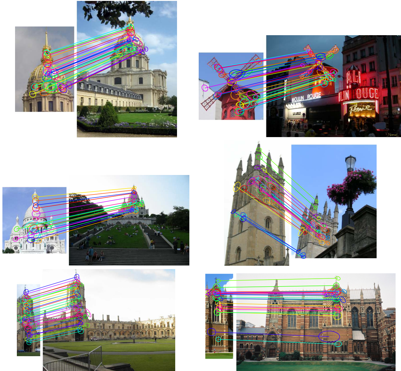
FIGURE 6 – Exemples de notre méthode DSM entre des images des jeux de données ROxford et RParis. Les “inliers” (ellipses) et correspondances (lignes) sont montrées de différentes couleurs.
